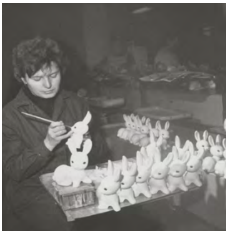
Ruční domalování detailů hraček z PVC / Finishing touches on PVC toys by hand, foto / photograph by the Moravian Provincial Archives in Brno
